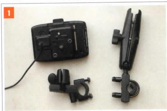
**Photo 1** Le support de fixation livré avec le GPS (à gauche) est loin d'être pratique ; autant le remplacer d'entrée par un système Ram-Mounts (à droite).
